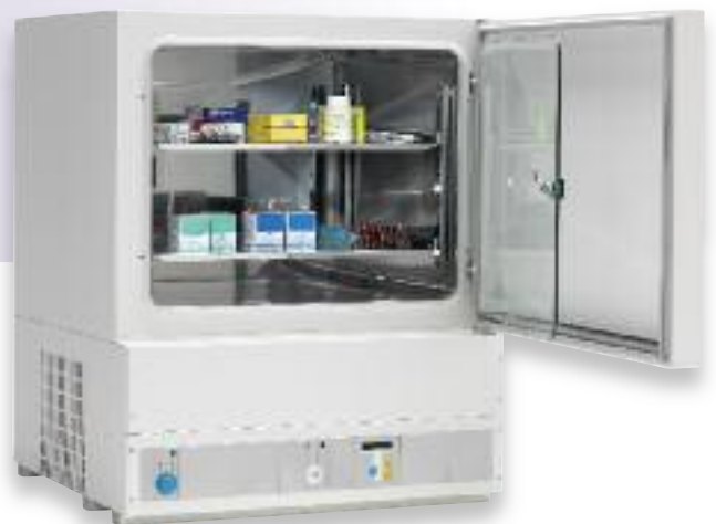
Heraeus BK 6160 - die thermische Ummantlung verhindert, dass die Probe austrocknet.
